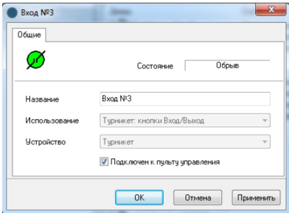
Если опция "Подключен к пульту управления" установлена, то данный вход контроллера будет отключен при выполнении команды "Запрет пульта управления" в окне управления. Работа входов будет возобновлена после выполнения команды "Разрешение пульта управления" в окне управления.
