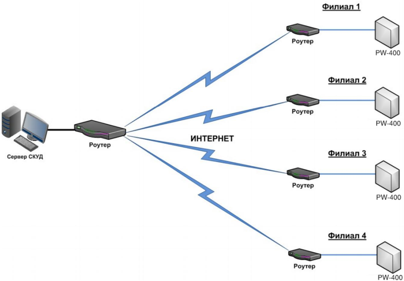
*При построении общей сети центрального офиса и филиалов для дополнительной защиты рекомендуется использовать VPN технологии, а для обеспечения резервирования каналов связи - роутеры с двумя разнородными каналами доступа в Интернет.*
