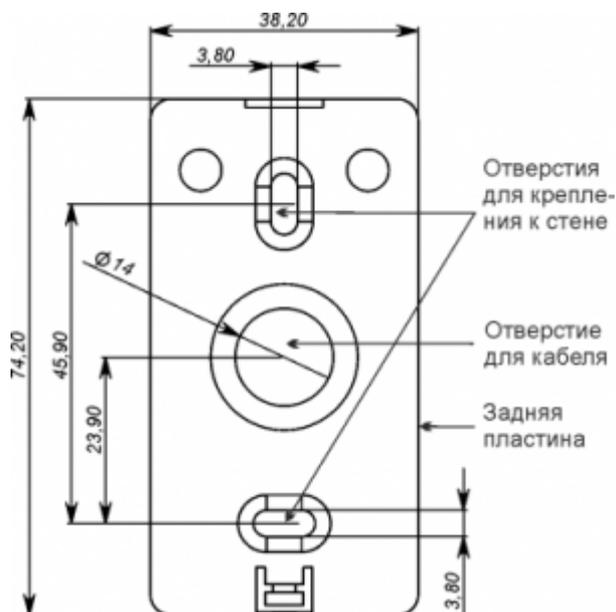
Пропустите кабель в центральное отверстие, закрепите заднюю пластину на стене с помощью прилагаемых пластиковых дюбелей и шурупов. Подключите считыватель к предварительно заложённому кабелю, соединяющему его с контролером. Вставьте считыватель в заднюю пластину, наденьте верхнюю крышку и зафиксируйте винтом (См. Рис 3).
