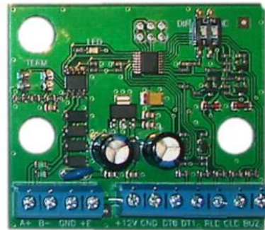
Преобразователь интерфейса Wiegand / RS485 PW-WRS
