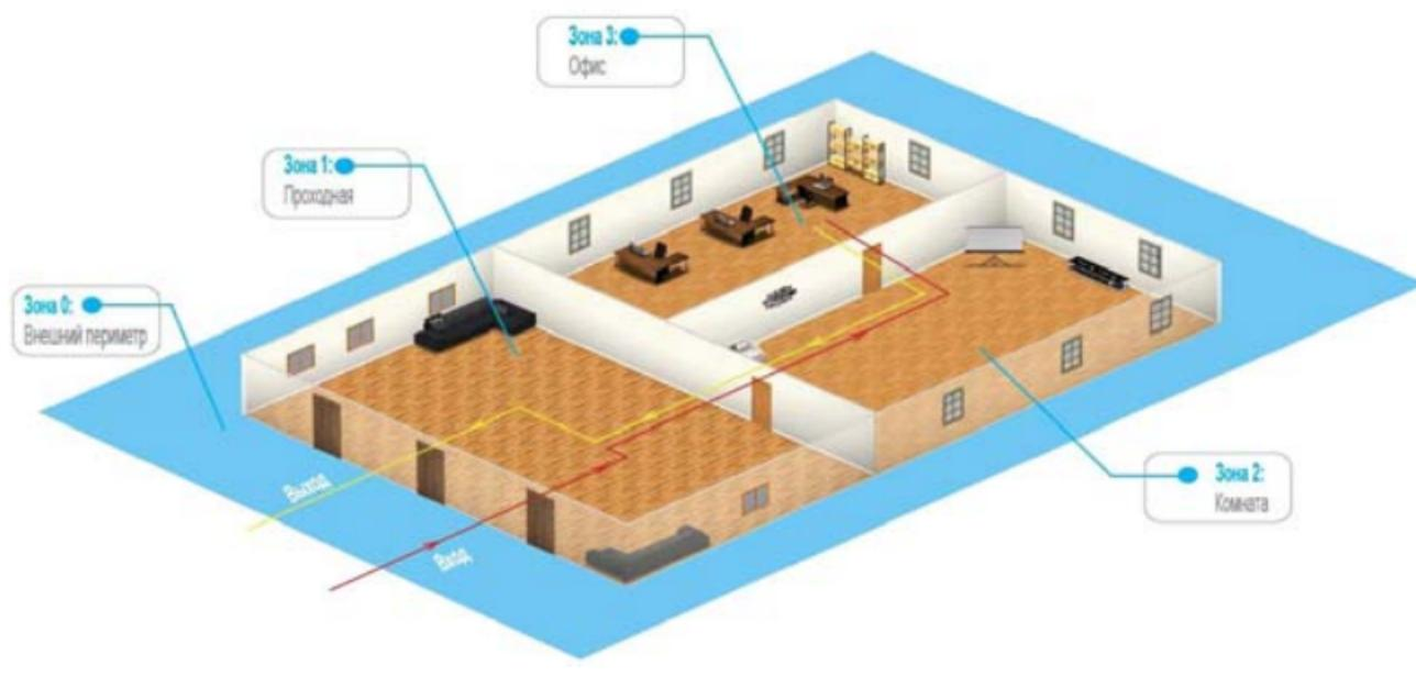
Изначально сотрудник (персона) имеет положение «Не определено» и только после первого поднесения идентификатора к считывателю его местоположение фиксируется контроллером PW А. Местоположение «Не определено» присваивается при регистрации нового сотрудника, либо после команды оператора системы «общий сброс местоположения».
