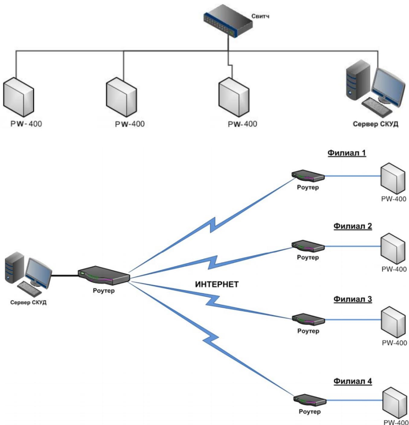
*При построении общей сети центрального офиса и филиалов для дополнительной защиты рекомендуется использовать VPN технологии, а для обеспечения резервирования каналов связи - роутеры с двумя разнородными каналами доступа в Интернет.*
